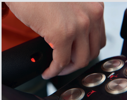
Capteurs de sécurité sur les deux poignées
